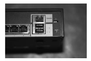
Ceci peut être simulé dans Packet Tracer en prenant le câble bleu et en connectant le port RS232 côté PC au port Console côté switch. Réalisez-donc cette première configuration avec un switch 2950-24:
